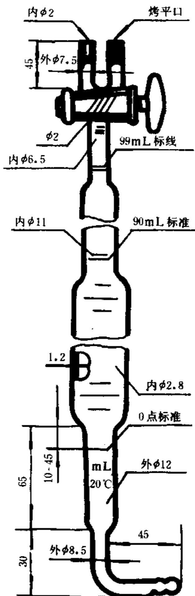
**图 A1 量气管****A1.2 量气管技术条件****A1.2.1-** 刻度表如图示的方向。**A1.2.2** 0 点、90 mL、99 mL 3 标线务应在相应的细管上,如图所示。**A1.2.3** 分度表:0 点标线至活塞关闭时为 100 mL。**A1.2.3.1** 0~90 mL
